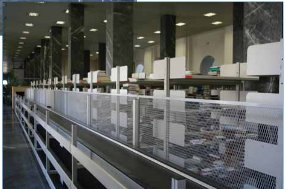
Voll automatisiert werden angefragte Bücher per Förderband zur Leihe transportiert. Das verkürzt die Wartedauer für die Besucher signifikant.
